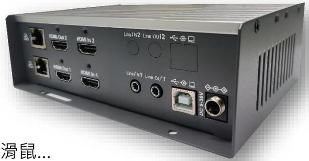
本產品是基於標準 IP 網路技術設計，發送端將所有輸入的訊號(影像、音訊、USB 等)即時轉換為 IP 封包(Multicast/Unicast)後再經由乙太交換機傳送至接收端，接收端再將此 IP 封包還原為影像、音訊、USB 等訊號，並輸出至各對應的設備，本產品接收端內建縮放功能，可將多個接收端配置成電視牆(Video-Wall)。適用於 AV 視聽廣播、KVM 矩陣控制、電視牆、數位資訊看板、等多元化應用，如視聽娛樂、會議室、法庭、醫療、軍事與教育等市場均可適用。
